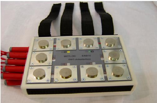
EAB mit 10 aufgelegten Saugelektroden
