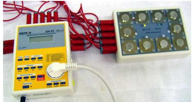
EAB in Anwendung mit einem Patientensimulator zur Applikation der EKG Signale auf die Saugelektroden
