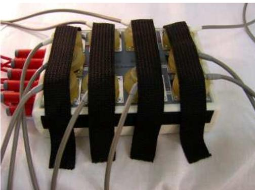
Der EAB zusammen mit dem elektrischen Sicherheitstester „ger“ zur Messung der Patientenableitströme
