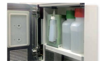
eingebautes Kühlsystem für CRP-reagenzien
