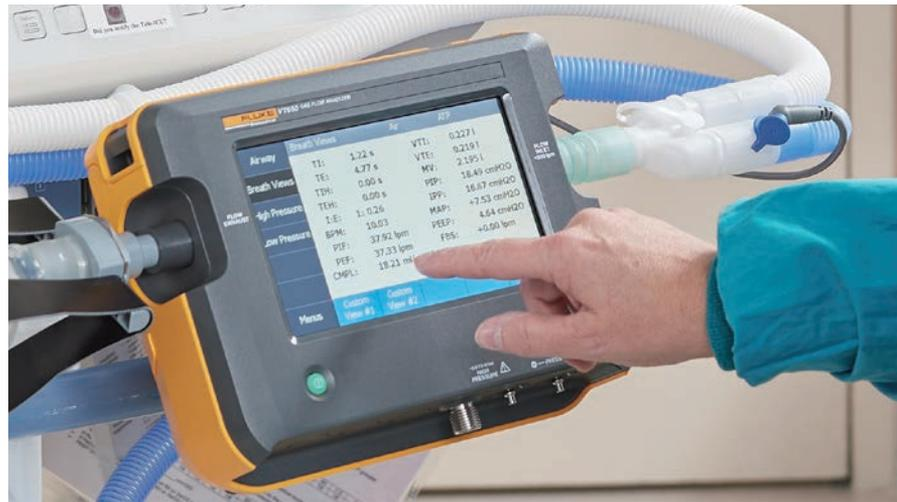
Eingebauter Speicher und USB-Stick für eine einfache Datenübertragung und das Hochladen einer Testdatei auf Ihr CMMS
